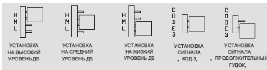
Рис 4: Установка перемычек для высокого, среднего и низкого уровня звукового давления, а также звукового сигнала код 3 и продолжительного звукового сигнала.
